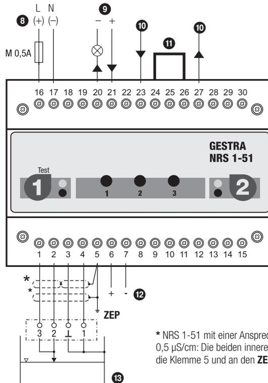
\* NRS 1-51 mit einer Ansprechempfindlichkeit von 0,5 µS/cm: Die beiden inneren Abschirmungen an die Klemme 5 und an den ZEP anschließen.
